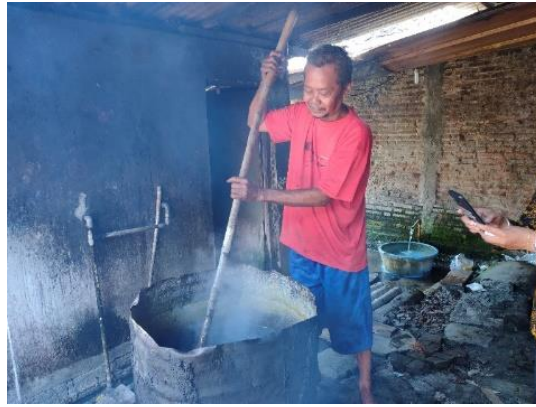
(Gambar 7 Pencelupan kain di dalam bejana)
