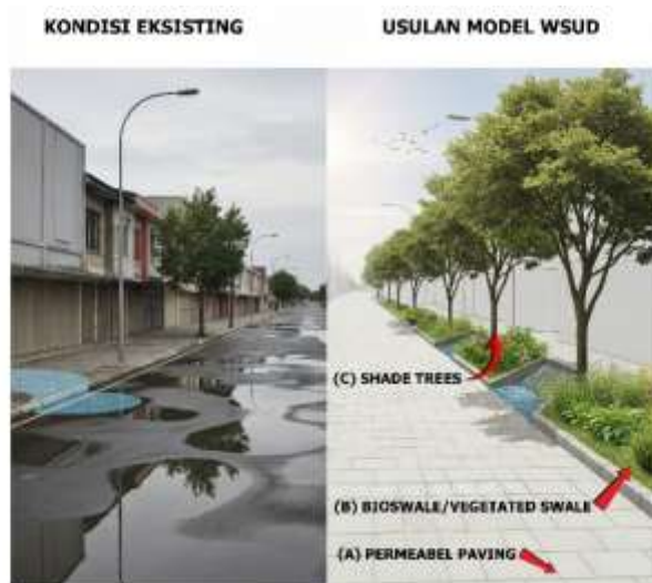
Gambar 3. Ilustrasi Model Konsep Integrasi Sirkulasi dan WSUD pada Akses Swadaya. (Kiri: Kondisi Eksisting dengan material kedap air dan genangan. Kanan: Usulan Model dengan material berpori (A) bioswale /drainase vegetasi, (B) sebagai area resapan, dan (C) vegetasi peneduh)
